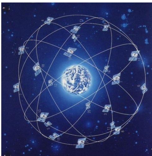
図-1 : GPS の衛星セグメント。30 機以上の衛星から構成される。
