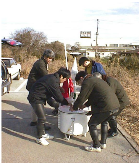
図-3：油壺実験で使われた最初の GPS ブイ。円筒形のブイの中に GPS 受信機と蓄電池が格納されている。ブイから鉛直に立てたピラーの上に水平に GPS アンテナが装着されている。斜めに取り付けられているのは無線通信用のアンテナ。
