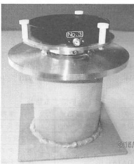
写真1 アンテナ水平維持機構外観
