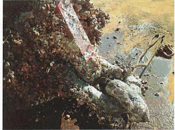
写真-3 係留環部とリンクNo.1 (回収後)
