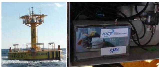
図 1 実験に用いたブイの外観及び小型地球局
