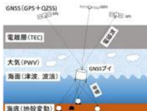
図 12 GNSS ブイを用いた総合防災システムの概念図
