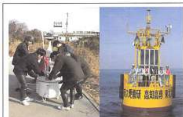
図2 GPS津波計ブイ。(左) 白い浮体が1997年に試験的に製作したブイ。(右) 2013年に高知室戸岬沖に設置したブイ。
