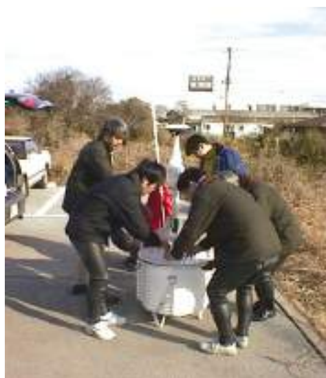
図－3：油壺実験で使われた最初の GPS ブイ。円筒形のブイの中に GPS 受信機と蓄電池が格納されている。ブイから鉛直に立てたビラーの上に水平に GPS アンテナが装着されている。斜めに取り付けられているのは無線通信用のアンテナ。
