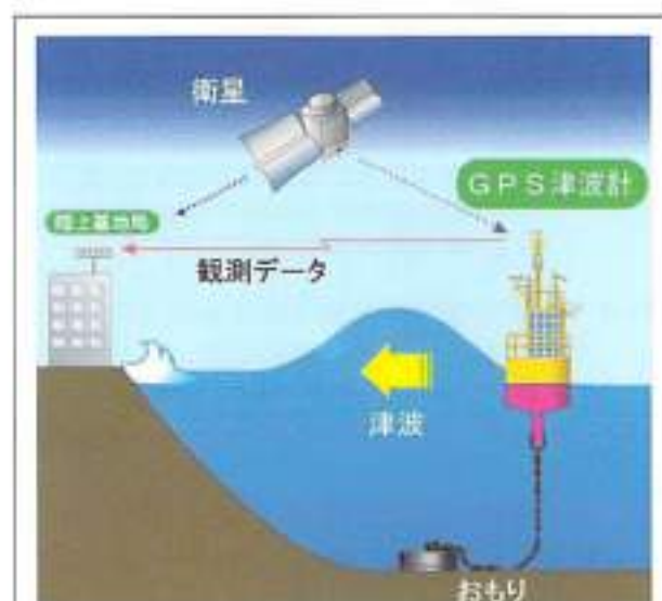
図 1 GNSS 津波計の概念。海面の動揺に追従するように設計されたブイの上下動を GPS を用いて精密 (cm オーダー) 測位を行い、その鉛直方向位置の時系列表示を海面変動表記とする。
