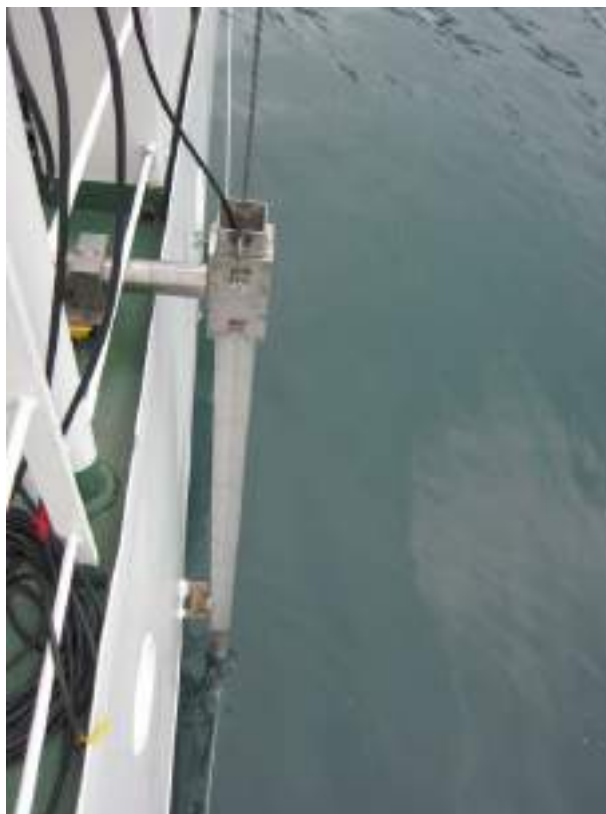
写真2 船上局測定器による音響調査
