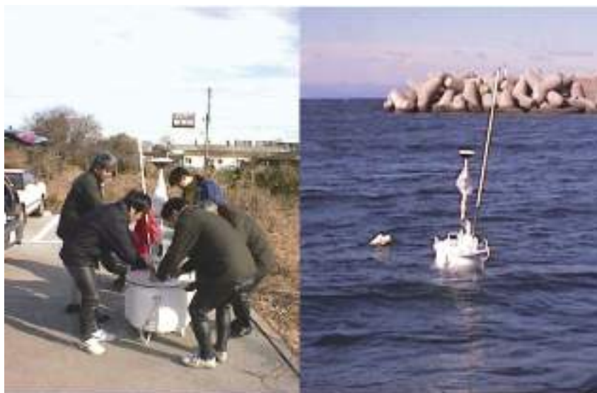
図 1 1997 年 1 月小網代湾で最初に使われた GPS ブイ。左：陸上で調整しているところ。右：湾内に浮かべたブイ。長い棒は無線送信アンテナ。短い棒の先についている平たい物体は GPS アンテナ。
