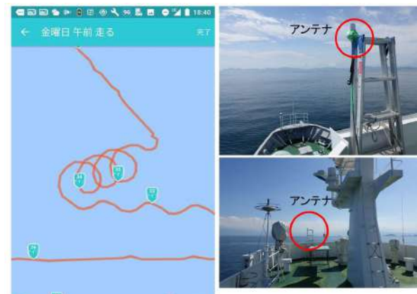
図 2-4: 弓削丸による Thuraya 用パッシブアンテナの受信実験. (左) 航跡図, (右) 甲板上に取り付けられたアンテナ
