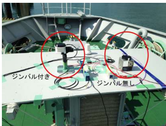
図 2-3: 弓削丸に取り付けられた ETS-VIII 用平面アンテナ. (左) ジンバル付き, (右) ジンバル無し.
