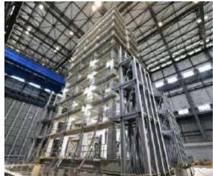
実大規模建造物の破壊過程の再現
